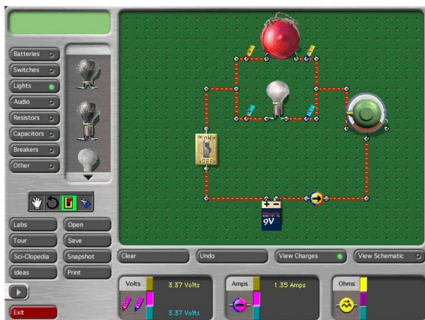
Slika 3: Simulacija paralelne veze dva potrošača sa prikazom toka struje
